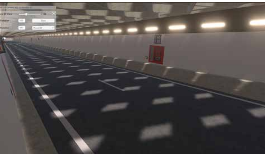
Figuur 3: Camerasilulatie helpt bij het correct monteren en instellen van het camerasysteem in de Velsertunnel
